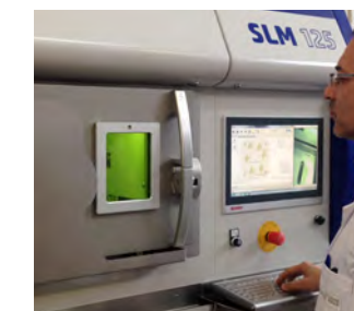
SLM 125 machine (laser power 400W)
