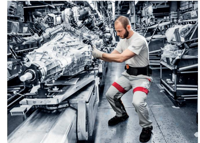
Die Titanteile zeigten sich als sehr widerstandsfähig. Beim ersten Feldversuch in der russischen Produktionsanlage eines Automobilherstellers setzten die potenziellen Kunden das Produkt hohen Lasten aus und liessen sich aus dem Sprung mit ihrem ganzen Gewicht in das Exoskelett fallen, um dieses gezielt zu beschädigen. Trotz dieser teils schwergewichtigen Prüfungen zeigte das Bauteil keine Anzeichen von struktureller Verformungen oder Instabilität.
