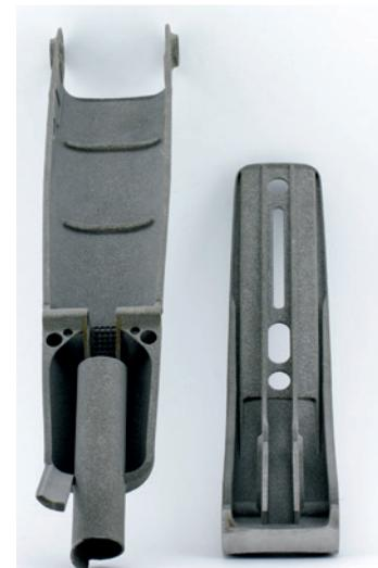
Der untere Bereich des Exoskeletts wurde für die additive Fertigung von zwei Schalen auf ein einzelnes konkaves Bauteil reduziert. Das Bauteil besitzt eine rauere Oberfläche an der Bauteilverbindung zum Dämpfer, bedingt durch den kritischen Ausrichtungswinkel im Bauraum der Maschine.
