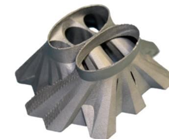
Die äusseren Stützstrukturen müssen aufgrund der komplexen Gestalt und geringen Wanddicke des Bauteils manuell entfernt werden. Anschliessend erfolgt die Glättung der Oberfläche mittels Sandstrahlen, wobei die Funktionsflächen an Verbindungspunkten zusätzlich manuell nachbearbeitet werden.
